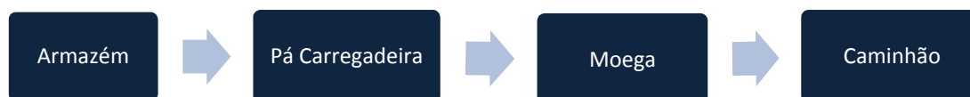
Figura 2 – Fluxograma da operação de expedição de sal e fertilizantes Fonte: Plano Mestre do Porto de Santos (2017)
